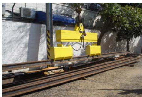
Levantamento de um único trilho
