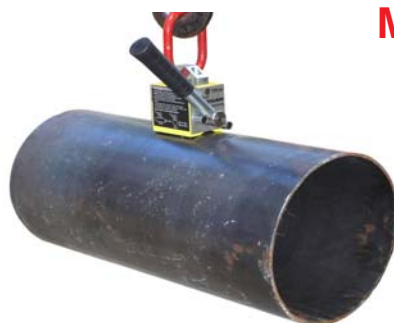
Pólos magnéticos com formato que permite o levantamento tanto de peças planas como de perfis redondos
