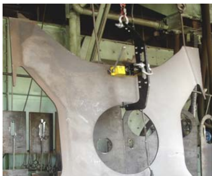
Pólos magnéticos com formato que permite o levantamento tanto de peças planas como de perfis redondos
