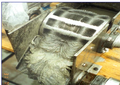
Alto poder de captura, com excelente retirada de partículas ferrosas
