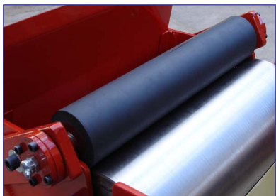
Rolo espremedor opcional de pressão constante por molas, que minimiza a perda de líquido, e rolo magnético totalmente revestido em aço inoxidável
