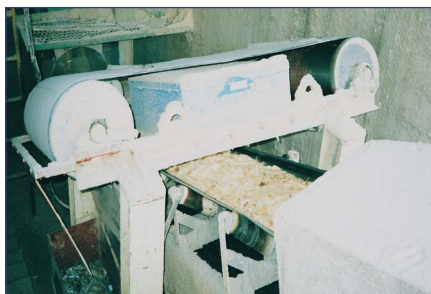
Posição típica e mais usual de instalação de Separadores Magnéticos Suspensos
